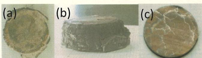
図 1 (a) Mg-RLI\_1 上面、(b) 側面、(c) 円柱状に加工した Mg-RLI\_1 の断面の写真
